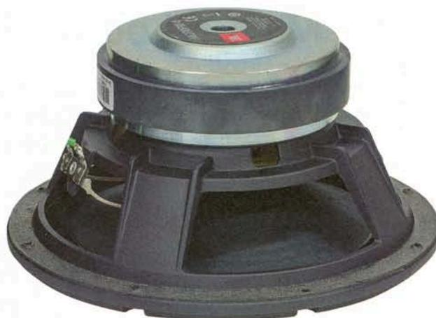
Il woofer da 200 mm ha la membrana realizzata in polpa di cellulosa sottoposta ad un trattamento costruttivo che ne massimizza la leggerezza e la rigidità. Notate le fessure per la circolazione ed il ricambio dell'aria attorno alla bobina mobile.
