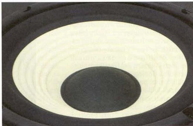
La membrana del woofer con la grossa cuffia parapolvere. Notare l'ondulazione della membrana che ne regolarizza la risposta e l'anello di sospensione esterna.
