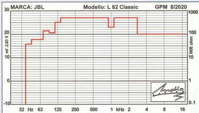
MOL - livello massimo di uscita: (per distorsione di intermodulazione totale non superiore al 5%)
