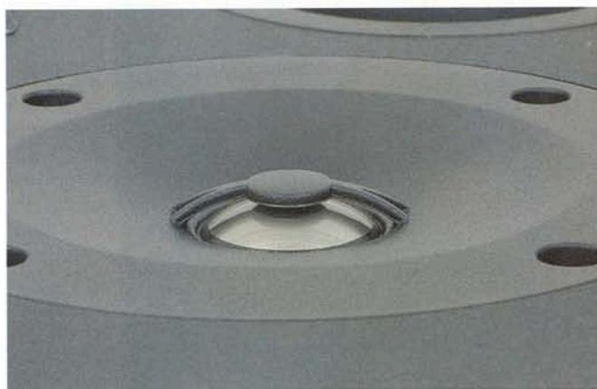
Un bel primo piano del tweeter. Notiamo l'anello di sospensione in gomma, il rifasatore sistemato avanti alla cupola ed il profilo della piccola guida d'onda.
